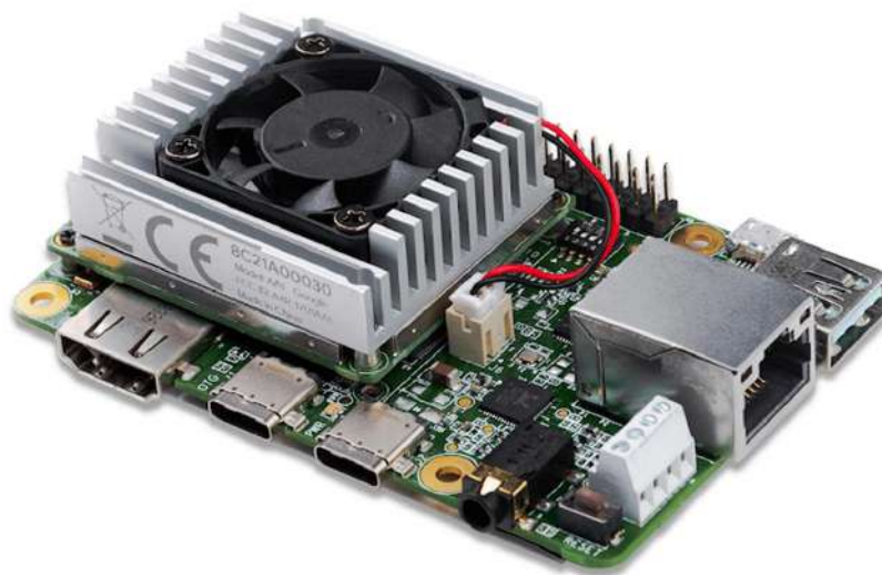
Рис.15.10. Плата розробника Coral Dev Board
