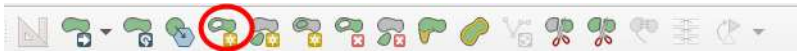
Рис. 2. 39. Інструмент Add Ring (Додати отвір) на панелі Advanced Digitizing Toolbar (Удосконалена панель для оцифрування)
