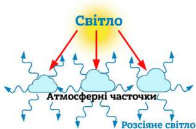
Рис. 2.5. Схема процесу розсіювання світла [5]
