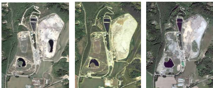
Рис. 4.113. Полігон ТПВ № 5 (ВАТ «Київспецтранс») на космічних знімках з ресурсу Google Earth (загальний вигляд та динаміка заповнення резервуара для зберігання фільтрату): а — 2007 р.; б — 2011 р.; в — 2018 р.
