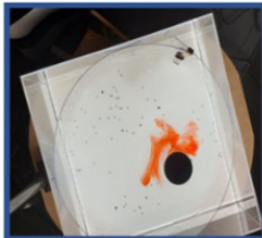
5. Резервуар із квадратною основою та перешкодою
