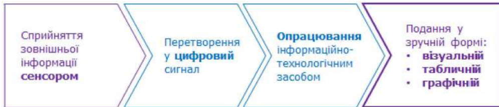
Рис. 12. Етапи опрацювання даних вимірювання засобами цифрового вимірювального комплексу
